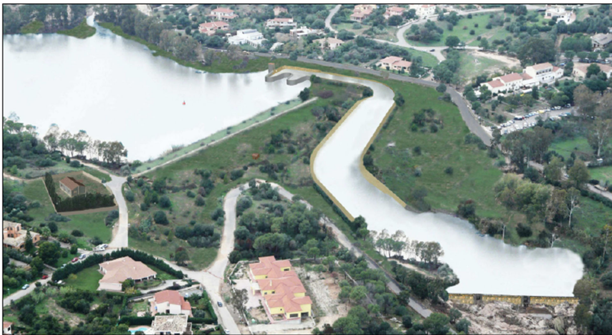
Figura 1 - Diga in terra di Poggio dei Pini sul rio San Girolamo: render del nuovo intervento sullo sfioro e sul canale fuggatore
